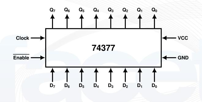
Almacena los valores de las entradas D<sub>i</sub> cuando se produce un flanco ascendente del Clock y se activa Enable.
